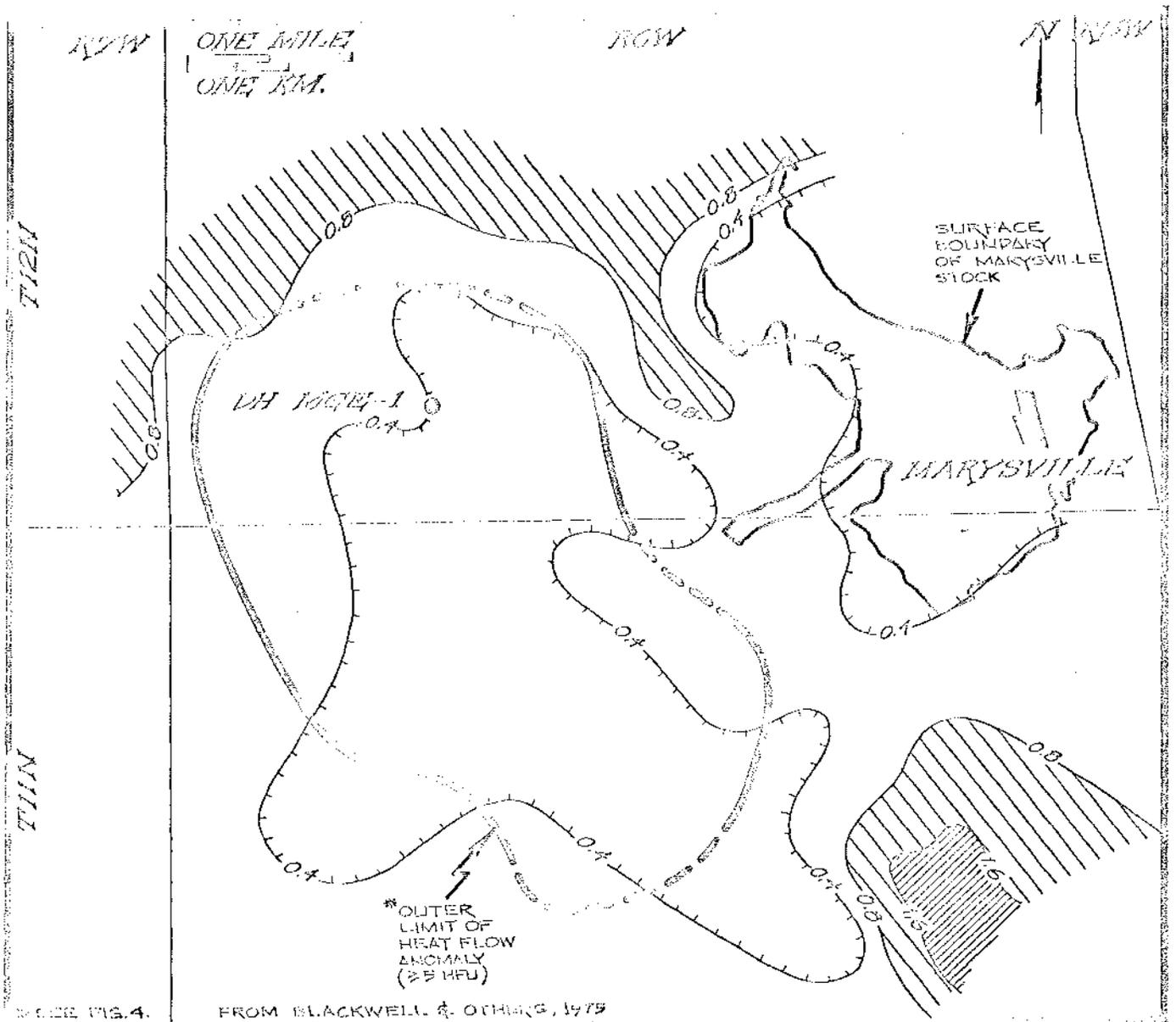
FIGURE 12. GROUND NOISE IN THE MARYSVILLE GEOTHERMAL AREA. QUANTITY CONTOURED IS GROUND NOISE AS THE SQUARE OF GROUND PARTICLE VELOCITY CALCULATED FROM THE INTEGRAL OF POWER DENSITY IN THE FREQUENCY BAND 1-2 Hz.
